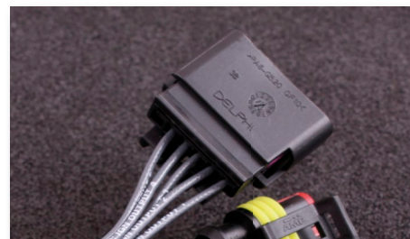
Fig 5.1a - 6-poliga kontaktdon. För inkoppling av t.ex. separata tändspolar.
