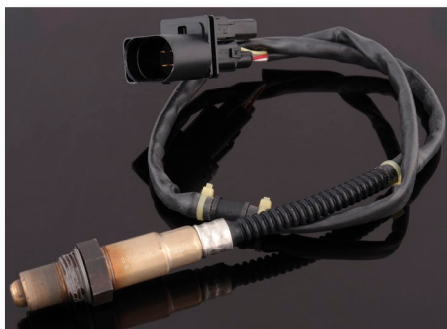
Fig 3.4.1b - Bosch LSU 4.2 bredbandslambda som även den alltid ingår i ett MaxxECU paket.
